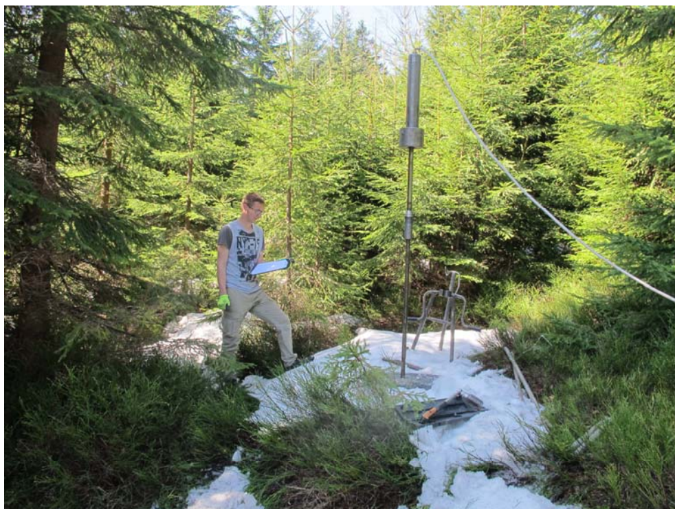
Obr. 3. Provádění dynamické penetrace DP11.
